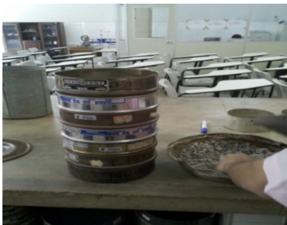
Figura 5: Análise granulométrica. Fonte: Autor.
