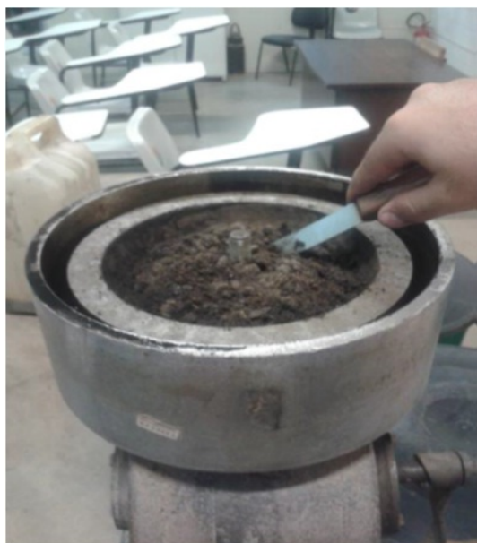
Figura 3: Componentes do asfalto fresado sem betume. Fonte: Autor.
