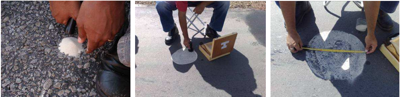
Figura 2. Espalhamento da areia e obtenção do diâmetro da mancha de areia.
