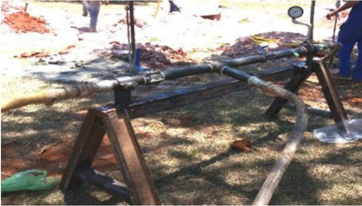
Figura 5. Sistema de bomba para injeção dos EB.
