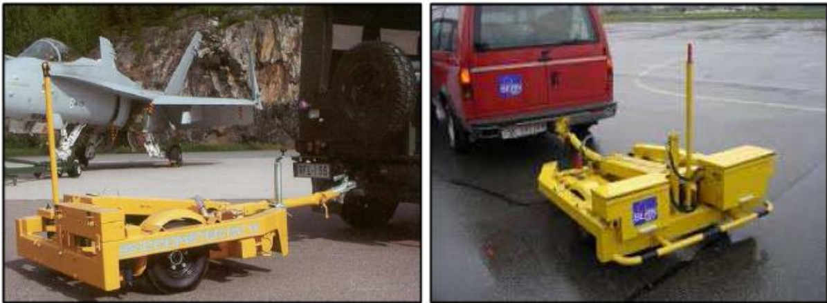
Figura 3: Equipamento para medição do coeficiente de atrito, Skiddometer . Fonte: Bezerra Filho e Oliveira (2013)
