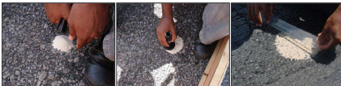
Figura 2: Espalhamento e medição da macrotextura, método da mancha de areia. Fonte: Oliveira (2009)
