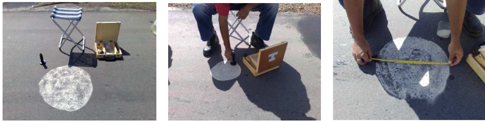
(a) material empregado. (b) espalhamento da areia. (c) medida do diâmetro do círculo.
