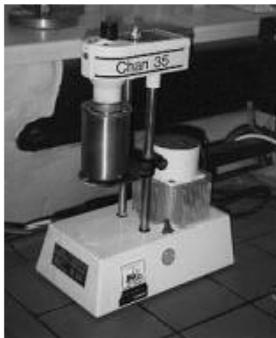
Figura 6: Vista do viscosímetro de rotação (Aguiar, 1997).
