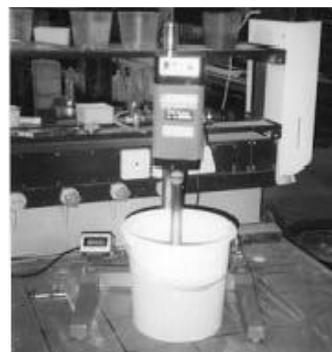
Figura 2: Misturador ULTRA-TURRAX T50 com medidor de rotação e equipamento de dispersão (Aguiar, 1997).
