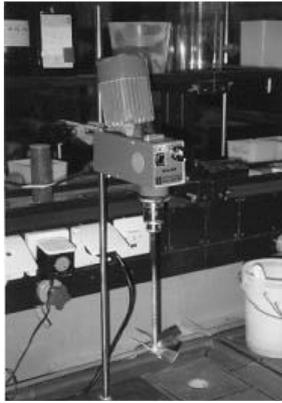
Figura 4: Agitador RW 20 com hélice (Aguiar, 1997).
