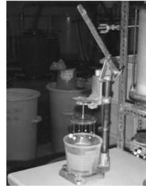
Figura 9: Vista do aparelho do ensaio de esfera (Aguiar, 1997).
