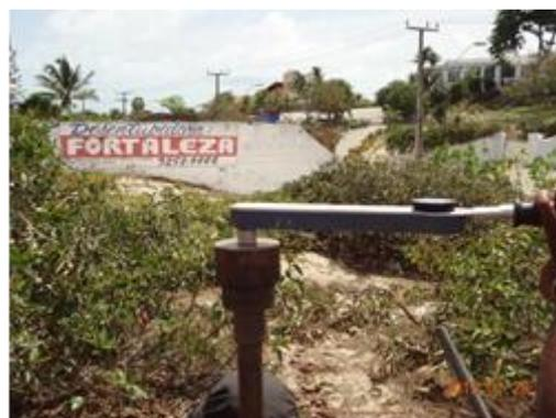
**Figura 04:** Torquímetro pronto para medição
