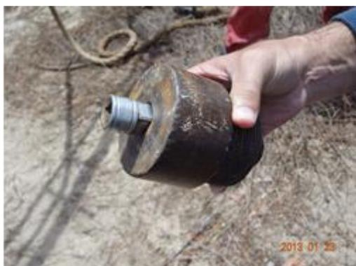
**Figura 03:** Cabeça de bater com pino adaptador
