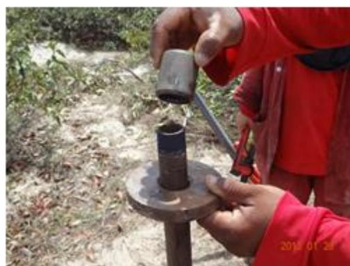
**Figura 02:** Disco centralizador com luva
