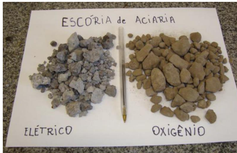
Figura 1. Exemplo de agregados britados de dois tipos de escória de aciaria (Tavares et al. , 2011).
