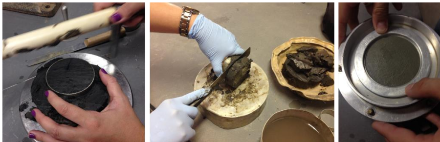
Figura 10. Moldagem do Corpo de Prova para o Ensaio de Adensamento.
