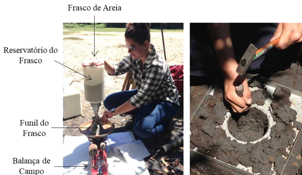
Figura 7. Procedimentos do Ensaio de Determinação da Massa Específica In-Situ .
