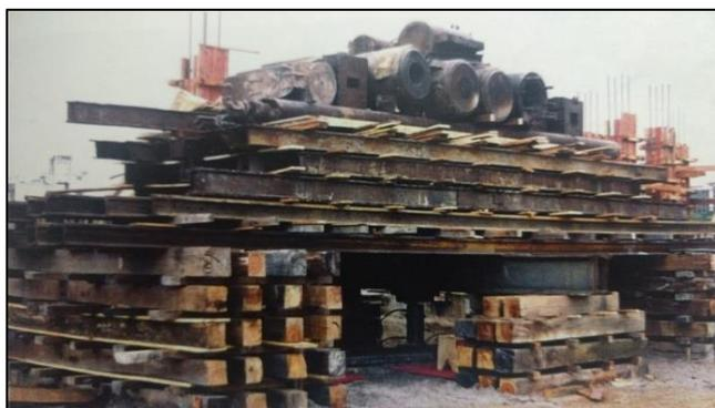
Figura 1 – Montagem da Cargueira Utilizada na Prova de Carga Estática
